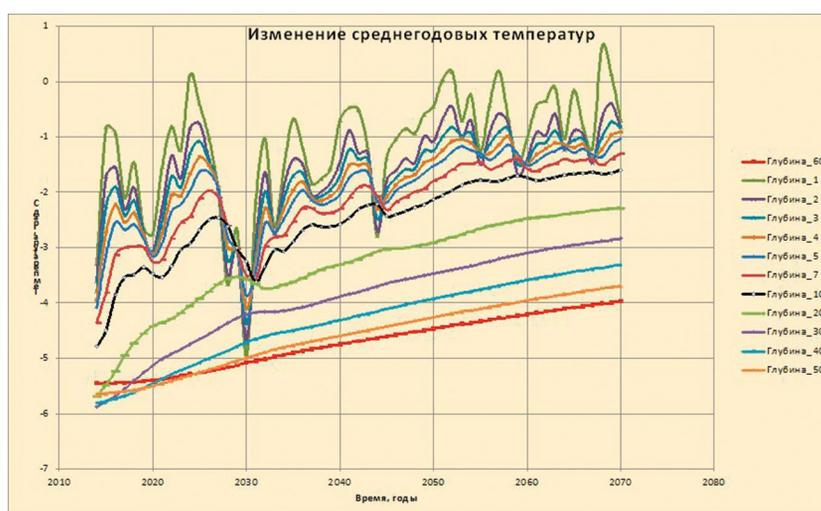
**Рис. 6.** Прогноз изменения температур грунта на разных глубинах для условий Центрального Ямала: сценарий RCP 8.5, глубина в метрах обозначена цветом, ненарушенные условия
